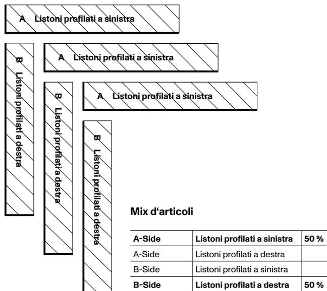
**Attenzione!** Per la posa di questo modello sono necessari 2 elementi: A-Side e B-Side, listone profilato a destra e listone profilato a sinistra.. Utilizzare le altre lame per altre stanze e/o altri pavimenti.
